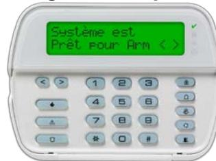
L'intégration de panneaux d'alarme peut être réalisée de deux façons à l'aide de la passerelle multisite. La première façon consiste à brancher la passerelle multisite directement aux panneaux d'alarme PowerSeries ou
